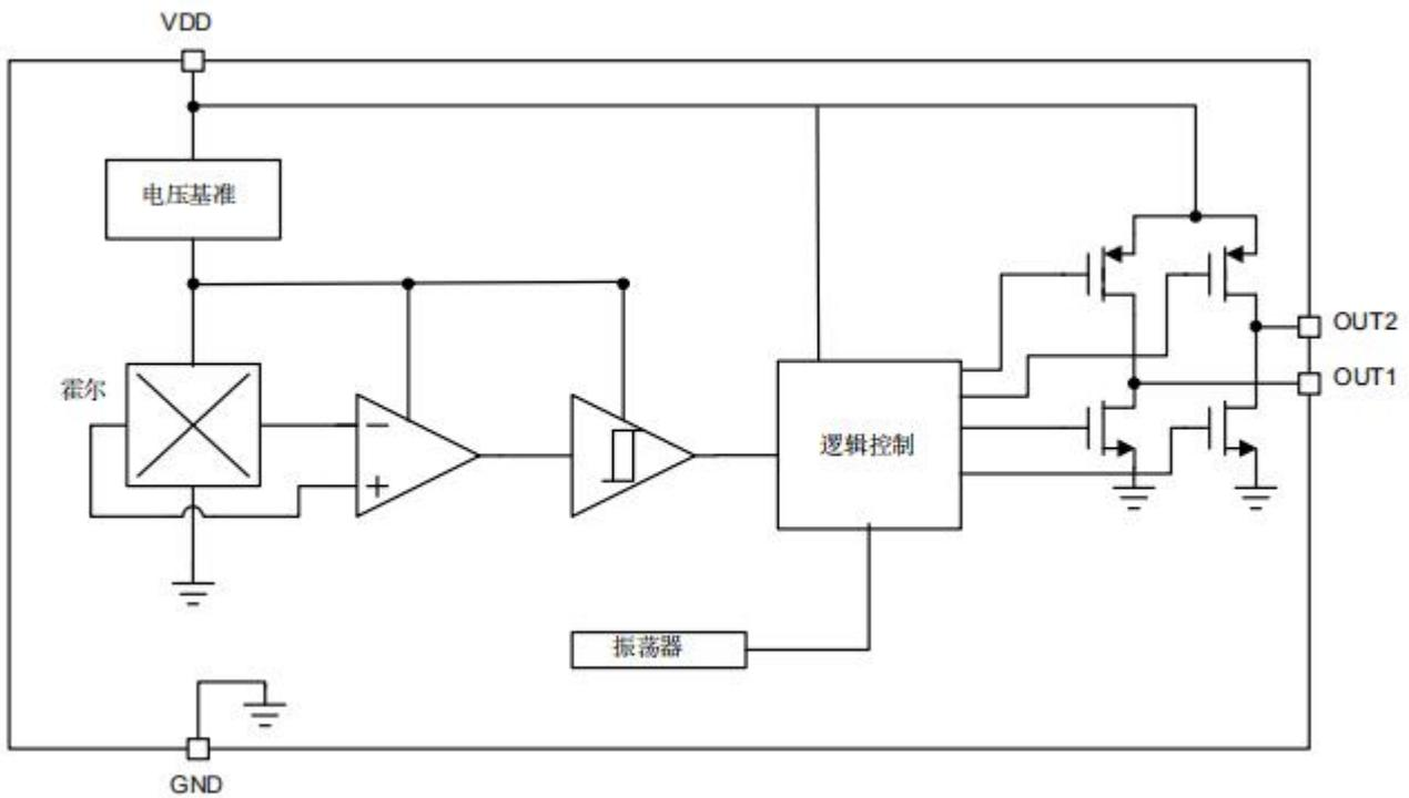
图 1, GH4322内部结构框示意图
